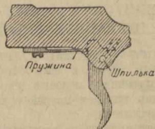
Рис. 16. Спусковой механизм укреплен между ушками ствольной коробки
