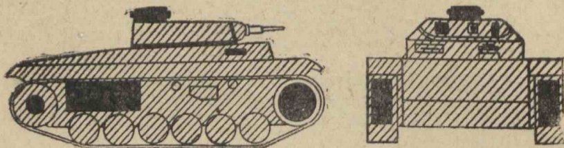
Рис. 5 и 6. Наиболее уязвимые места германского танка „Т-III“.
