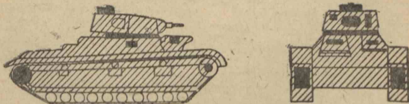
Рис. 10 и 11. Наиболее уязвимые места германского тяжелого танка завода „Рейнметалл“.
