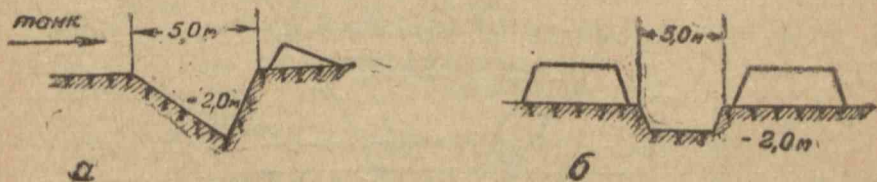
Рис. 27. Противотанковые рвы: а) Треугольный ров. б) Ров в форме трапеции.
