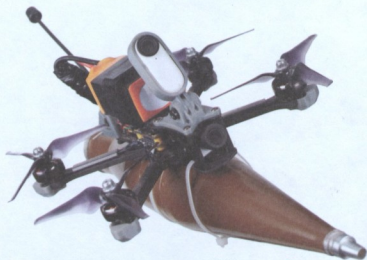
Проект самодельного ударного БПЛА, изготовленного из гражданского коммерческого квадрокоптера с подвешенной гранатой от РПГ
